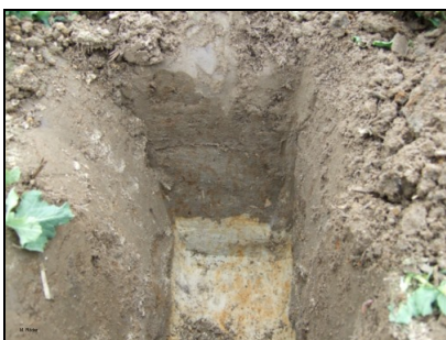
Abb. 27: Pseudogley-Gley aus Lösslehm über Sand an der B6; 06.05.2014
